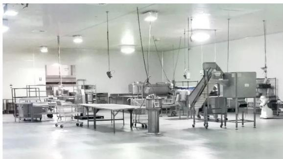
Revêtement de sol en résine hygiénique Flowfresh ESD SR UV : Flowfresh ESD SR UV proposé par Tremco est un nouveau revêtement de sol en résine hybride Flowcrete à base de PU Ciment, sans joint, conducteur/ESD, à très haute résistance à l'abrasion, résistant aux produits chimiques et aux UV, avec une finition colorée brillante et antidérapante.
